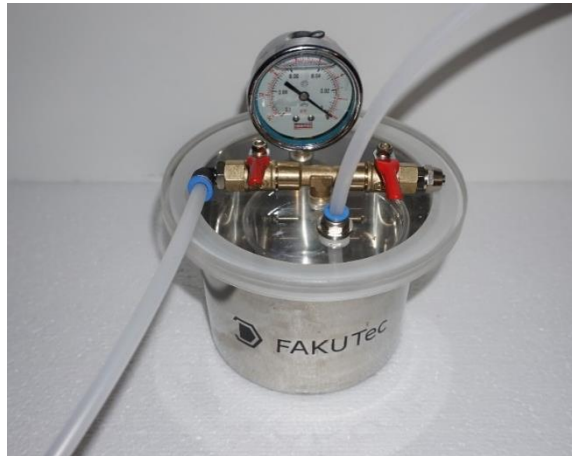
Die günstige Lösung als Harzfalle, zum Entgasen und für die Vakuuminfusion
